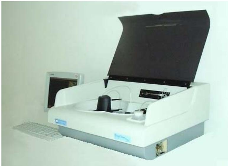
**Analyseur robotisé à cycles optimisés**, doté d'un panier pour 60 cuvettes d'échantillon, blancs, contrôles et standards.
